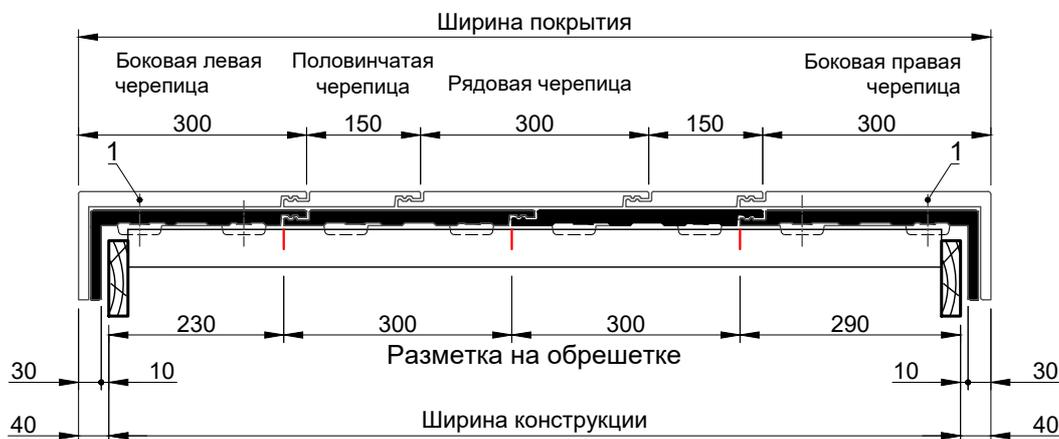
1 - Коррозионностойкий самонарезающий винт (далее саморез) 4,5x50 мм
