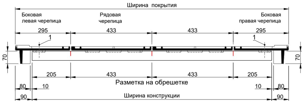
1 - Коррозионностойкий самонарезающий винт (далее саморез) 4,5x50 мм.
